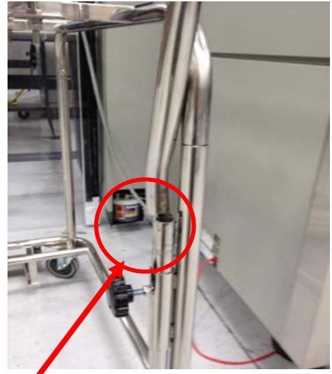
Obrázek 2. Místo, kde se tlačná tyč odlamuje
